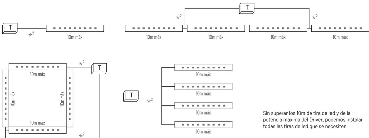
Sin superar los 10m de tira de led y de la potencia máxima del Driver, podemos instalar todas las tiras de led que se necesiten.
