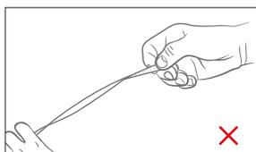
La tira led no puede ser deformada ya que puede dañar los componentes de la misma.
