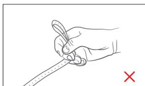
La curvatura no puede realizarse en angulos muy ajustados ya que puede partir sus pistas interiores.
