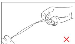
La tira led no puede ser deformada ya que puede dañar los componentes de la misma.
