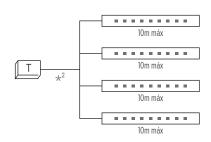
Sin superar los 10m de tira de led y de la potencia máxima del Driver, podemos instalar todas las tiras de led que se necesiten.
